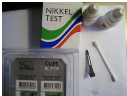
Foto. Nikkelfrigivelse fra hårklips, undersøges ved testkit købt på apoteket. Lyserød farve på vatpinden indikerer, at nikkelfrigivelsen fra hårklipsen er høj.
